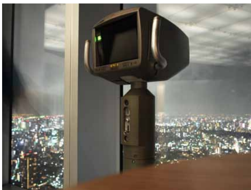
BĚŽNÝ DALEKOHLED NA VYHLÍDKOVÉ PLOŠINĚ NAHRAZEN KAMEROVÝM SYSTÉMEM. V TOMTO PŘÍPADĚ NA ÚKOR FUNKCE.
